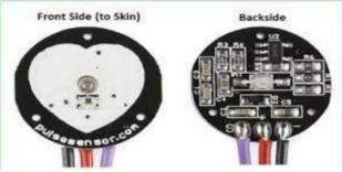
Fig: 2.2. Pulse Sensor
