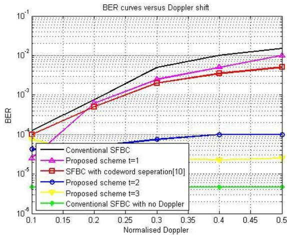
**Simulation data:** For SFBC-OFDM  $N=10^6$ ,  $t=3$ ,  $\text{noise}=10^8$ ,  $\gamma=13.24$ ,  $k=0.5$ ,  $N_s=512$ ,  $L=5$ .
