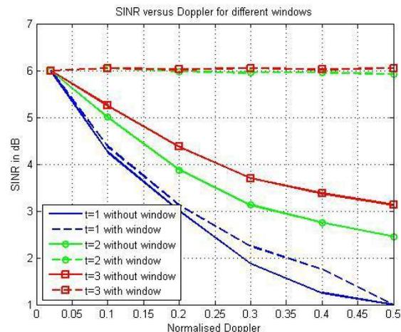
Simulation data: For Doppler shift  $N=10^6$ ,  $t=3$ ,  $\text{noise}=10^8$ ,  $\gamma=13.24$ ,  $k=0.5$ ,  $N_s=512$ ,  $L=5$ .
