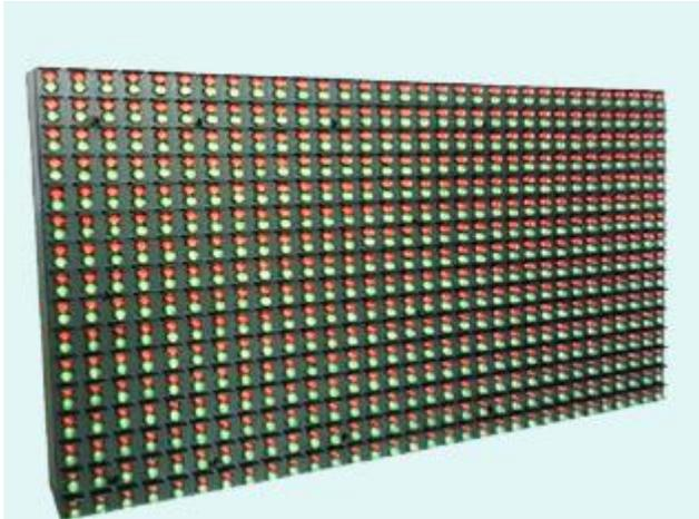
**Fig. 3. P10 LED TILE FRONT VIEW**
