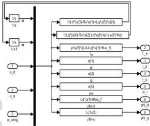
**Fig. 3. Implementation of PMSM in Simulink in dq frame**
