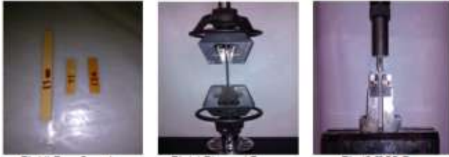
Fig(d) Test Samples Fig(e) Flexural Test Fig(f) ILSS Test
