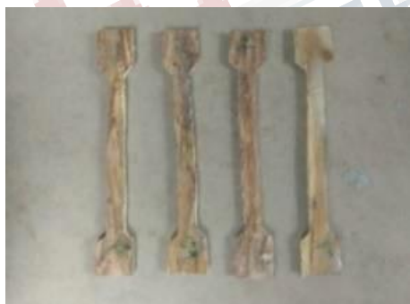
Fig.1. Tensile test specimens
