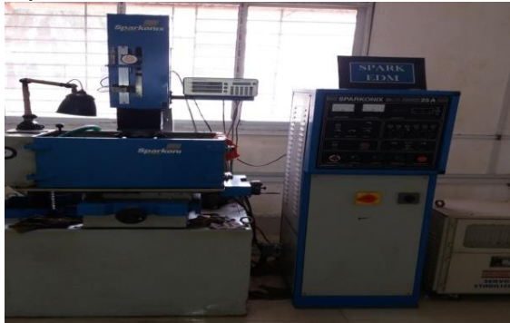
Fig. 1: (a) Die Sinker EDM Model: SPARKONIX mos SN25
