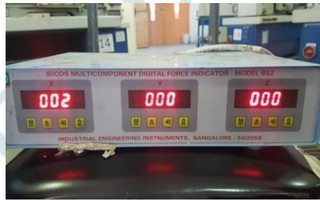
Fig (5) dynamometer device( model 652)
